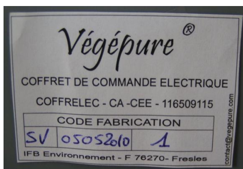
Étiquette de traçabilité du coffret de commande accolée dans le coffret ou sur une des faces extérieures
