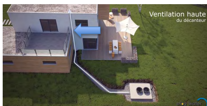
Fig-29: Ventilation haute modèle 5EH monocuve 3m 3
