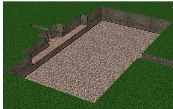
Lit de pose du filtre à écoulement vertical
