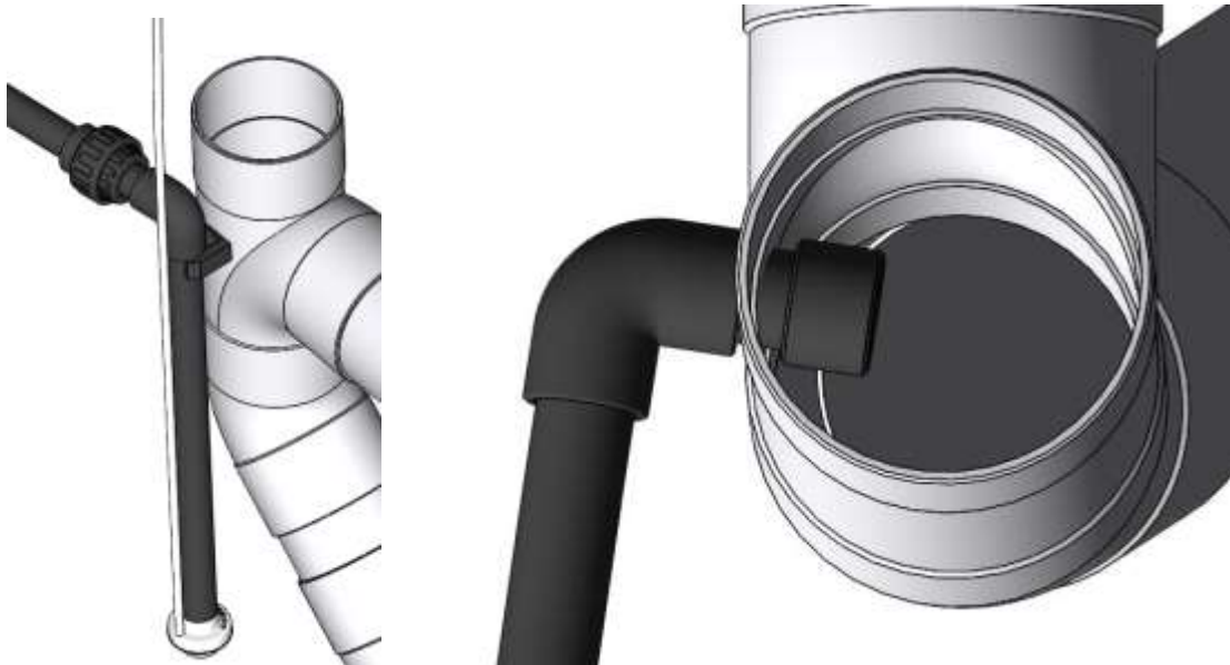
Figure 11: Dispositif de recirculation Airlift et Refoulement des eaux traitées en entrée de décantation
