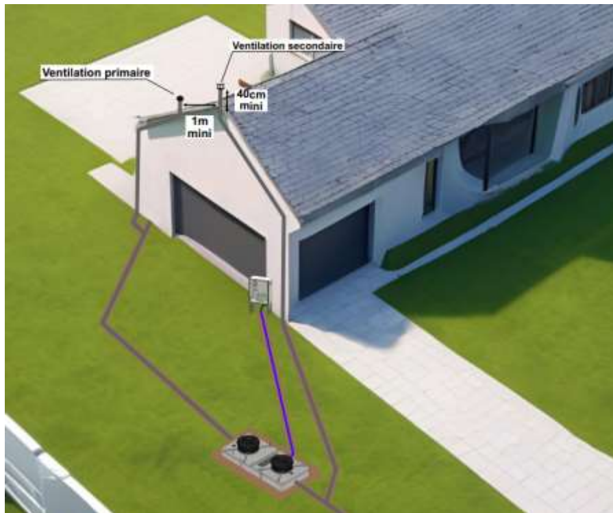
Figure 35 : Ventilations de la filière GINETT
