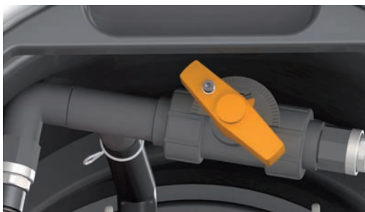
vanne en position initiale
